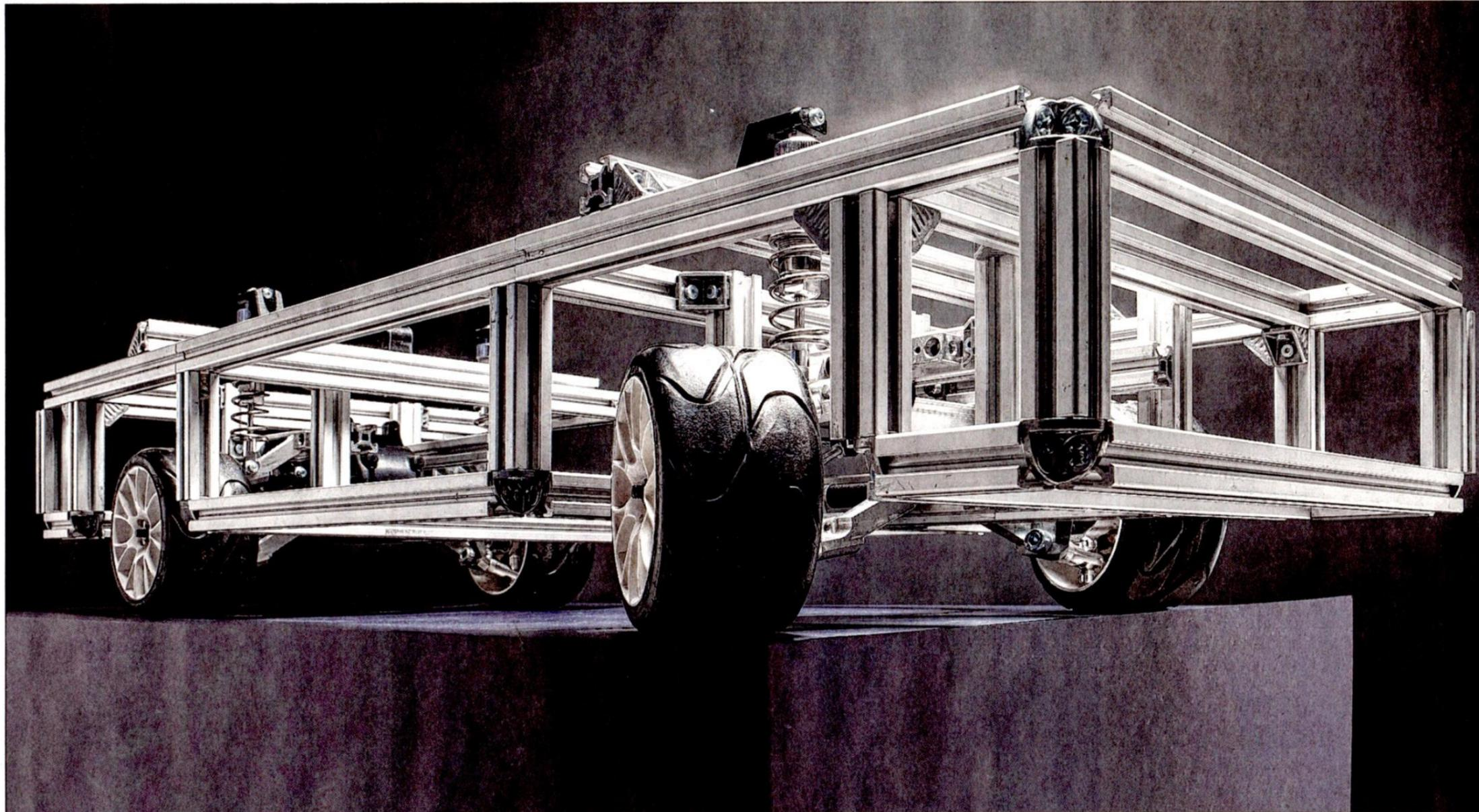
EIN HAUCH VON FISHER-BAUSATZ: Mit diesem Demonstrator im Modellmaßstab werden am KIT neue Antriebs- und Lenkkonzepte für Elektroautos getestet.
