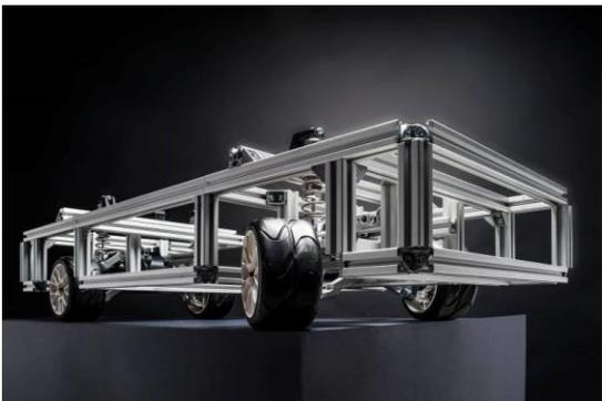
BU: Mit dem Demonstrator im Modellmaßstab werden neue Antriebs- und Lenkkonzepte für Elektroautos am KIT getestet. (Bild KIT/ M. Breig)
